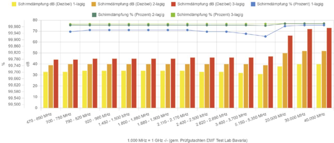
Schirmdämpfung - HiFreq-Standard-Powder - 8 m<sup>2</sup> pro Liter - 470 MHz bis 40.000 MHz (40 GHz)
