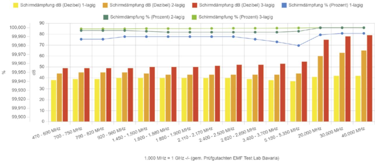
Schirmdämpfung - HiFreq-Standard-Liquid - 8 m² pro Liter - 470 MHz bis 40.000 MHz (40,0 GHz)
