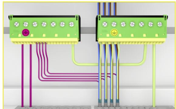
Funktionspotentialausgleich zur Verdeutlichung markieren. Haupterdungsschiene wie gewohnt an PE anschließen, Sammelschiene FPA und Sammelschiene PE mit  $\geq 4 \text{ mm}^2$  Querschnitt verbinden.
