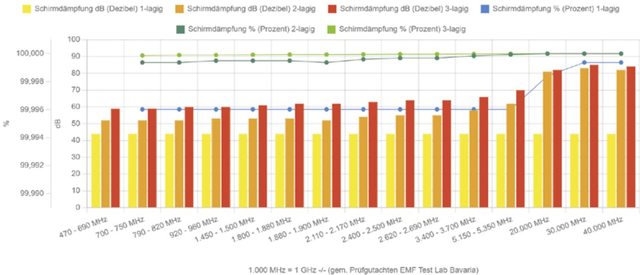
Schirmdämpfung - HiFreq-Premium - 8 m³ pro Liter - 470 MHz bis 40.000 MHz (40 GHz)
