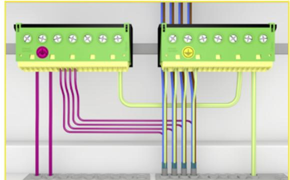
Funktionspotentialausgleich zur Verdeutlichung markieren. Haupterdungsschiene wie gewohnt an PE anschließen, Sammelschiene FPA und Sammelschiene PE mit  $\geq 4 \text{ mm}^2$  Querschnitt verbinden.
